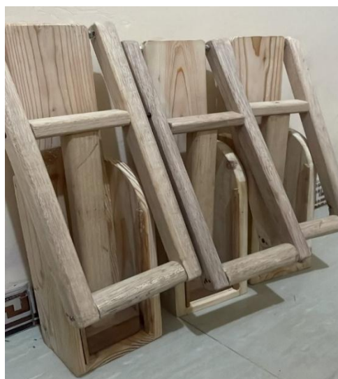
Gambar 1. PRESBOT SEMARAK, alat pengepres botol plastik berbasis konstruksi kayu yang dibuat oleh mahasiswa KKN.
