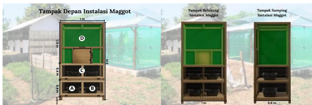
Gambar 3. Prototipe pembagian ruang kandang Maggot Black Soldier Fly (BSF), (A) fase telur - instar 1, (B) fase instar 2 - 3, (C) Instar 4 - prepupa, (D) Pupa - peneluran.
