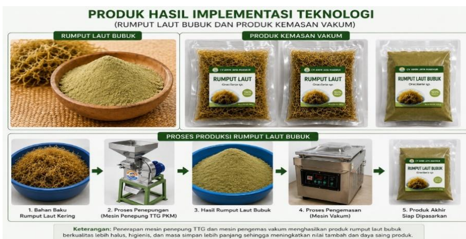
Gambar 2. Produk hasil implementasi teknologi: alur penepungan rumput laut, hasil bubuk, pengemasan vakum, dan produk akhir.
