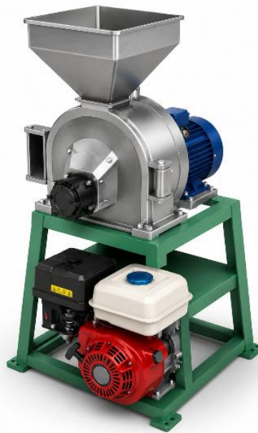
Gambar 3. Mesin penepung rumput laut yang digunakan dalam implementasi TTG.
